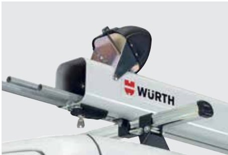
Σωλήνας μεταφοράς και φόρτωσης σωλήνων
